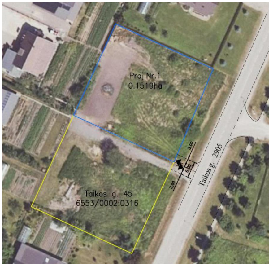
Pav. 5. Esamos nuovažos praplatinimas pagal aiškinamąjį raštą nr. 155863
